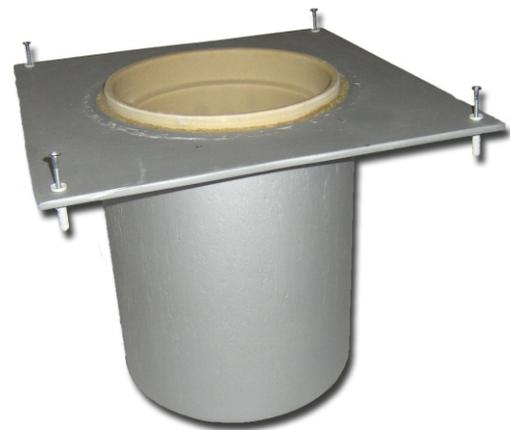
Die HILLEN Deckenhülse für auf die Feuerstätte aufgesetzte Schornsteine oder Schornsteine ohne Sohle. Die Deckenhülse trägt die statische Last der Innenrohrsäule des Schornsteins und ermöglicht einen brandschutzsicheren Anschluss des Verbindungsrohrs der Feuerstätte. Das Bauteil ist mit einem keramischen Einsatz und einer Mineralfaserdämmschicht ausgeführt.
